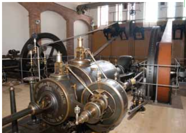
Dva parní stroje, každý o výkonu 100 koňských sil, dodala firma Breitfeld a Daněk. Strojní vybavení stálo 250 tisíc tehdejších korun.
